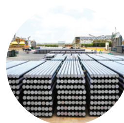
Cắt phần thừa 2 đầu, còn lại 6.3m Cut off the waste ends to 6.3m Billets
