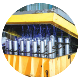
Làm lạnh đột ngột qua khuôn Rapidly cool down while pouring into mandrel
