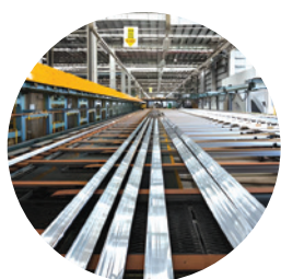
Đùn ép kéo 2 đầu qua khuôn mẫu Extrusion - puller through the mold
