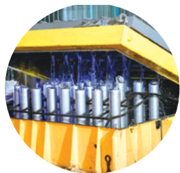
Làm lạnh đột ngột khi qua khuôn Rapidly cool down while pouring into mandrel
